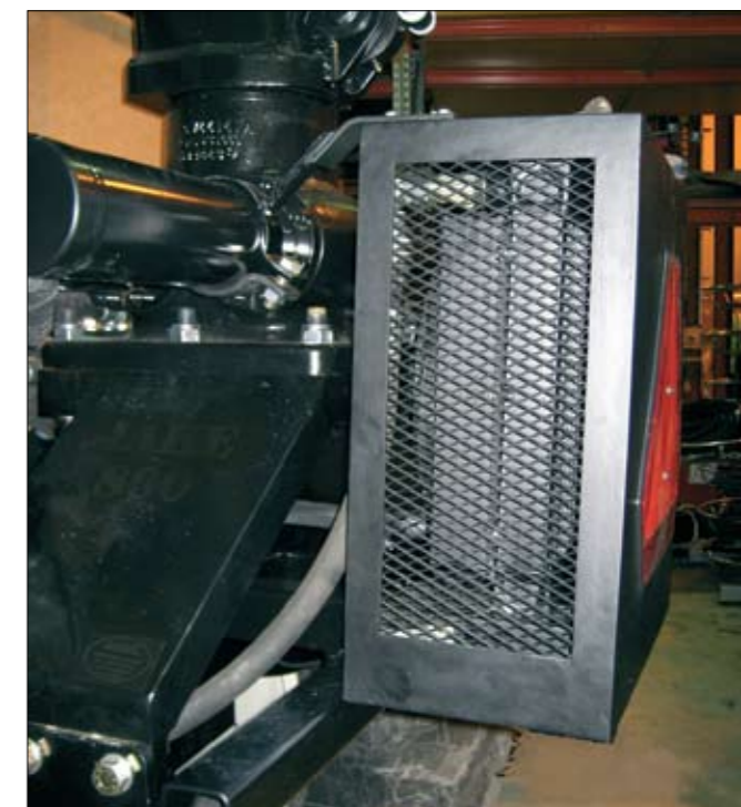
Chladič oleja: Pri práci pri vysokých teplotách, alebo pri práci s harvesterovou hlavou, či s ťažobnými kliešťami je chladič oleja nevyhnutný.
