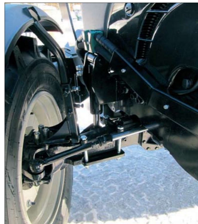
Sada pre uzamknutie prednej nápravy traktorov Valtra. Sada pozostáva z dvoch hydr. valcov, hadíc a ventilu. (len pevné nápravy)
