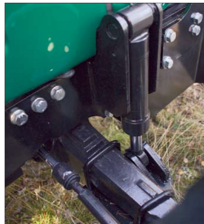
Sada pre uzamknutie prednej nápravy traktorov Valtra. Sada pozostáva z dvoch hydr. valcov, hadíc a ventilu. (len pevné nápravy)
