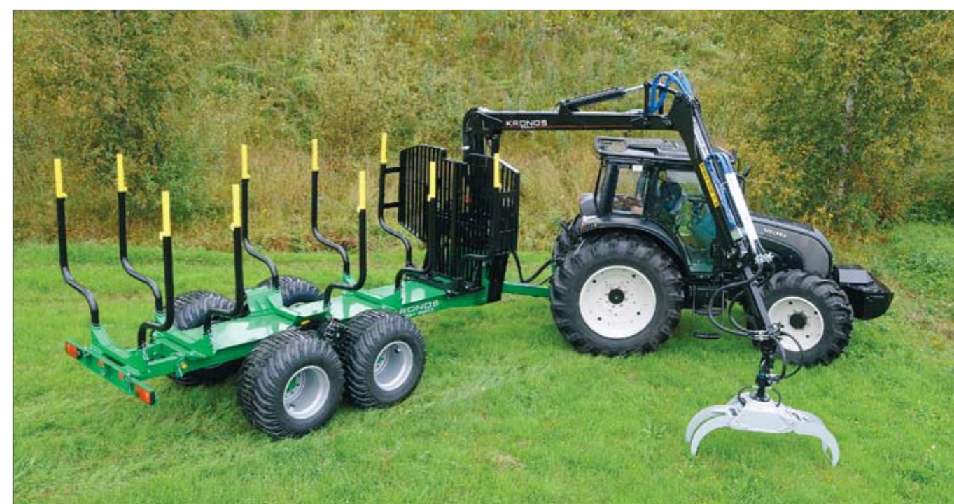
Vývozka 125 4WD s predĺžením ramu, pneumatiky 600/60 22.5 ELS
